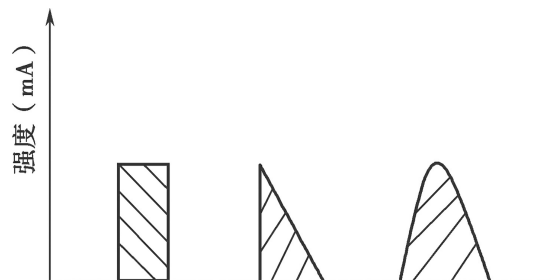
图3-1 不同波形的有效作用面积
